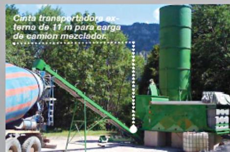
Cinta transportadora externa de 11 m para carga de camión mezclador.
